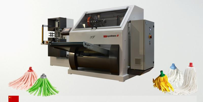
半自动拖把装配机。适用于棉、无纺、水刺布、微纤等各种原料的加工。设计目的为用塑料或钢制盖和叉子装配拖把。叉子必须是两销式。 在机械驱动压力下,由一名操作员手动进行盖子和叉子的装载。由光电池防护物确保安全。在加载压力后,一旦操作人员将手从监控区域移 开,机器就自动启动。
